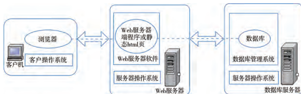
图4-5 三层的浏览器/服务器结构
